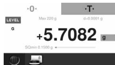
Fig. 1 : le capteur opto-électronique LevelControl avertit lorsque la mise à niveau est incorrecte
