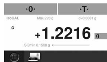
Fig. 3 : le poids minimum d'échantillon requis est satisfait, la valeur de pesage est correcte.
