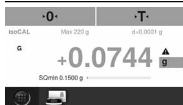
Fig. 4 : le poids minimum d'échantillon n'a pas été atteint, la valeur de pesage n'est pas correcte.
